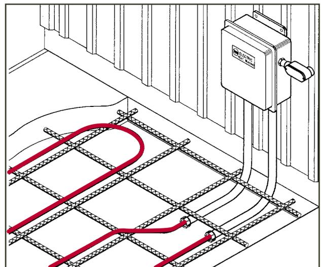
**Figure 4.1** Junction Box/Conduit
